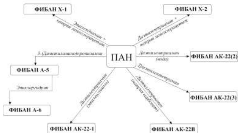
Рисунок 4 – Схема получения волокнистых ионитов на основе ПАИ волокон
