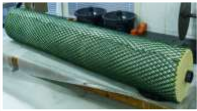
Рисунок 3 – Ионообменный фильтр на основе нетканого анионообменного полотна ФИБАН.
